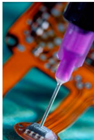
Agents d'encapsulation pour circuits imprimés flexibles/ Collage de fils
